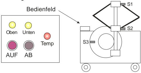
In einer ersten Abschätzung wurden bereits 3 Steuerungstypen in die engere Wahl gezogen: Eine Klein-SPS (LOGO!), eine Lösung mit eigener Mikrocontroller-Hardware und eine verbindungsprogrammierte Steuerung mit Schützen. Finden Sie mit Hilfe der Bewertungsmatrix die bestgeeignete Steuerung.
